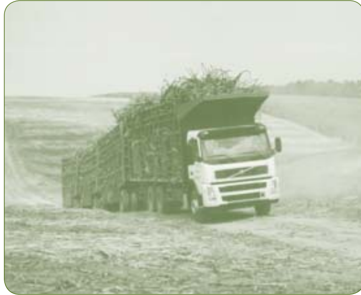
Transporte de cana-de-açúcar com treminhão no Brasil.
