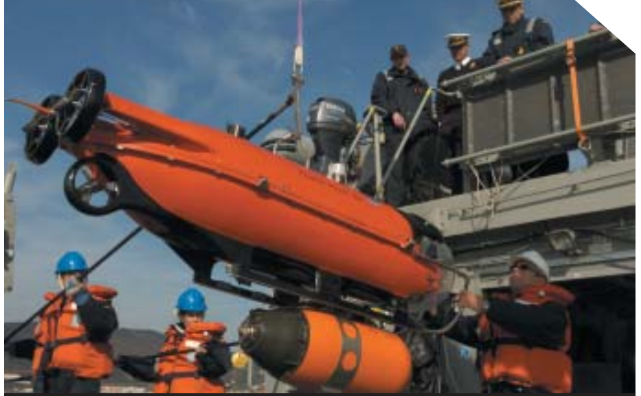
El vehículo submarino Pluto está capacitado para el reconocimiento visual de objetos sospechosos y, en caso de ser minas, para moverlas o neutralizarlas.
