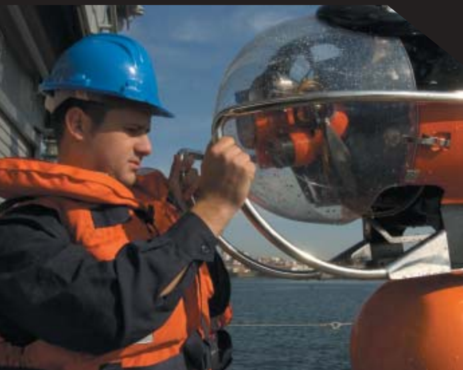
A bordo del cazaminas Duero , un tripulante inspecciona el vehículo submarino dirigido por control remoto Pluto tras una misión de reconocimiento.
